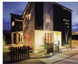
ライティングで足元を明るくしっかりと視界を確保することで、つまずきや転倒などの思わぬトラブルを防ぎます。また、防犯のみならず、家の価値を高めてくれます。タカショーのライティングには独自のローボルト(12V)ライティングシステムがあり、電気工事の資格が不要な工事のため、エクステリアと一緒に施工可能で、トランスが付くため照度センサー機能やタイマーなど暮らしの質を高める使い方ができます。
